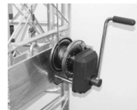
Handwinde zum Ausfahren des Mastes
