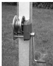
Handkurbel am Stahl-Hilfsmast zum Kippen des Alu-Teleskop-Mastes
