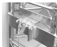
Mechanische Verriegelung des ausgefahrenen Mastes
